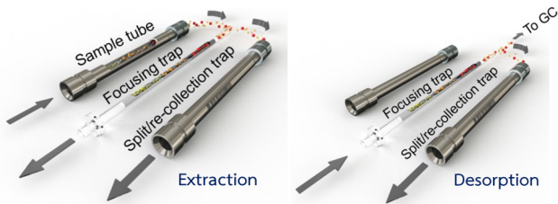
รูปที่ 3 ขั้นตอนการทำงานของ Thermal Desorption ผลิตภัณฑ์ Markes International จากประเทศอังกฤษ
