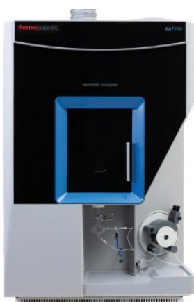
รูปที่ 2 แสดงเครื่อง ICP-OES รุ่น iCAP PRO XP
