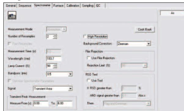
Figure 1: Spectrometer parameters
